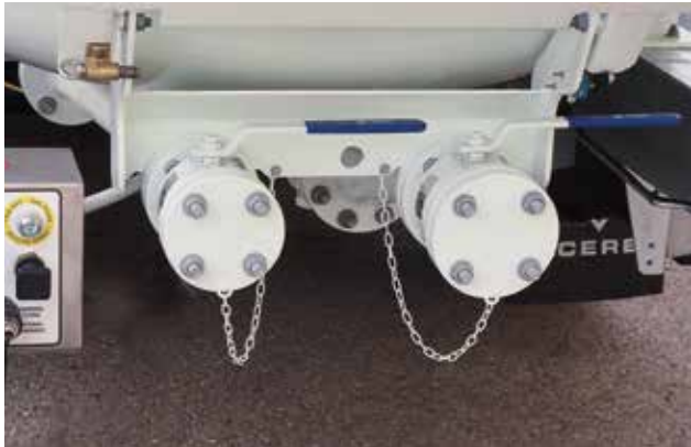
Installation de déchargement postérieur service dépôt
